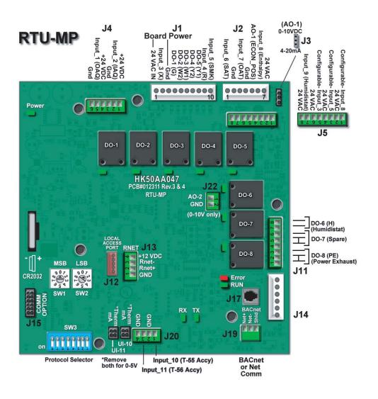
Fig. 59 - RTU-MP Multi-Protocol Control Board
